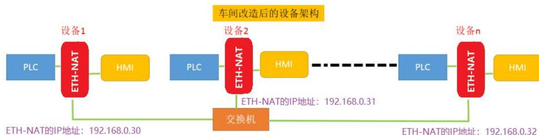
在不改变原系统（PLC和HMI）设置的情况下，通过ETH-NAT的NAT地址转换，可实现设备联网的方案需求。
