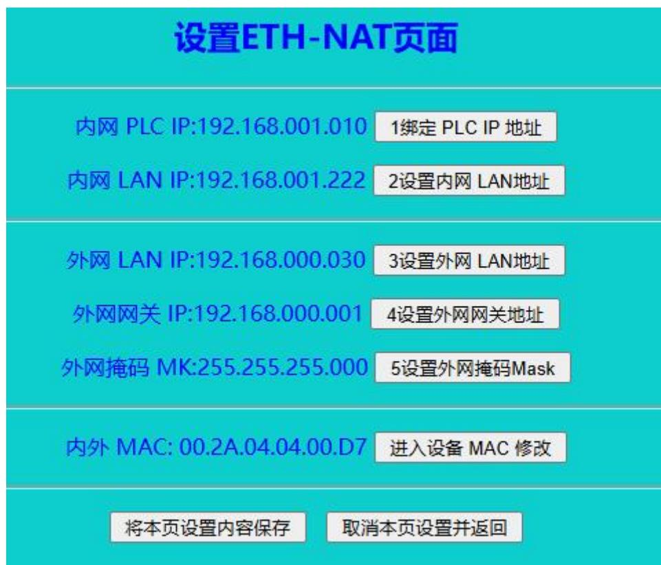
PLC为S7-200SMART，其实际IP地址为：192.168.1.10，上位机IP为192.168.0.100，通过ETH-NAT跨网段转换，就可以实现上位机在此网段与PLC通讯。
