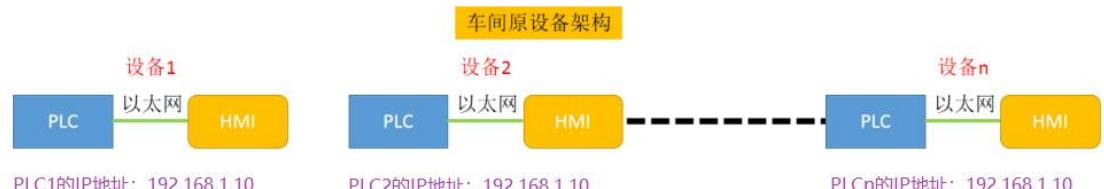
每套设备原本都是独立的系统，每个PLC的IP地址都是相同的，并且无法修改PLC的IP地址，如果现在需要增加一台计算机，实现对现场所有PLC的数据采集，简单的把PLC都连入交换机，显然由于IP地址冲突，此方案将无法实现。
