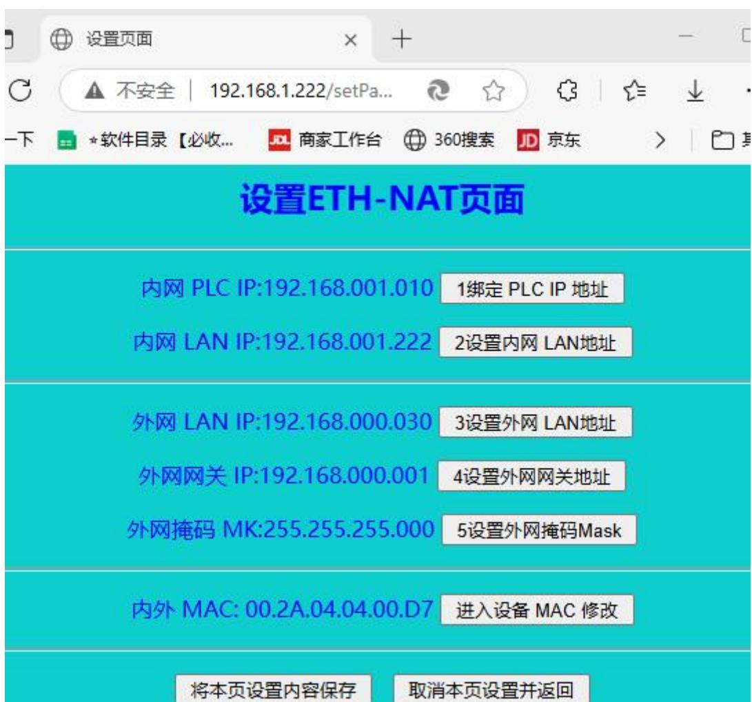
设置ETH-NAT内网PLC的IP地址，必须保证内网LAN的IP地址与连接的内网PLC的IP地址在同一网段
