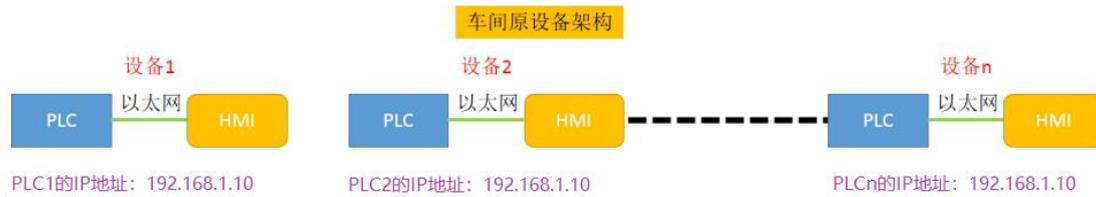
每套设备原本都是独立的系统，每个PLC的IP地址都是相同的，并且无法修改PLC的IP地址，如果现在需要增加一台计算机，实现对现场所有PLC的数据采集，简单的把PLC都连入交换机，显然由于IP地址冲突，此方案将无法实现。
