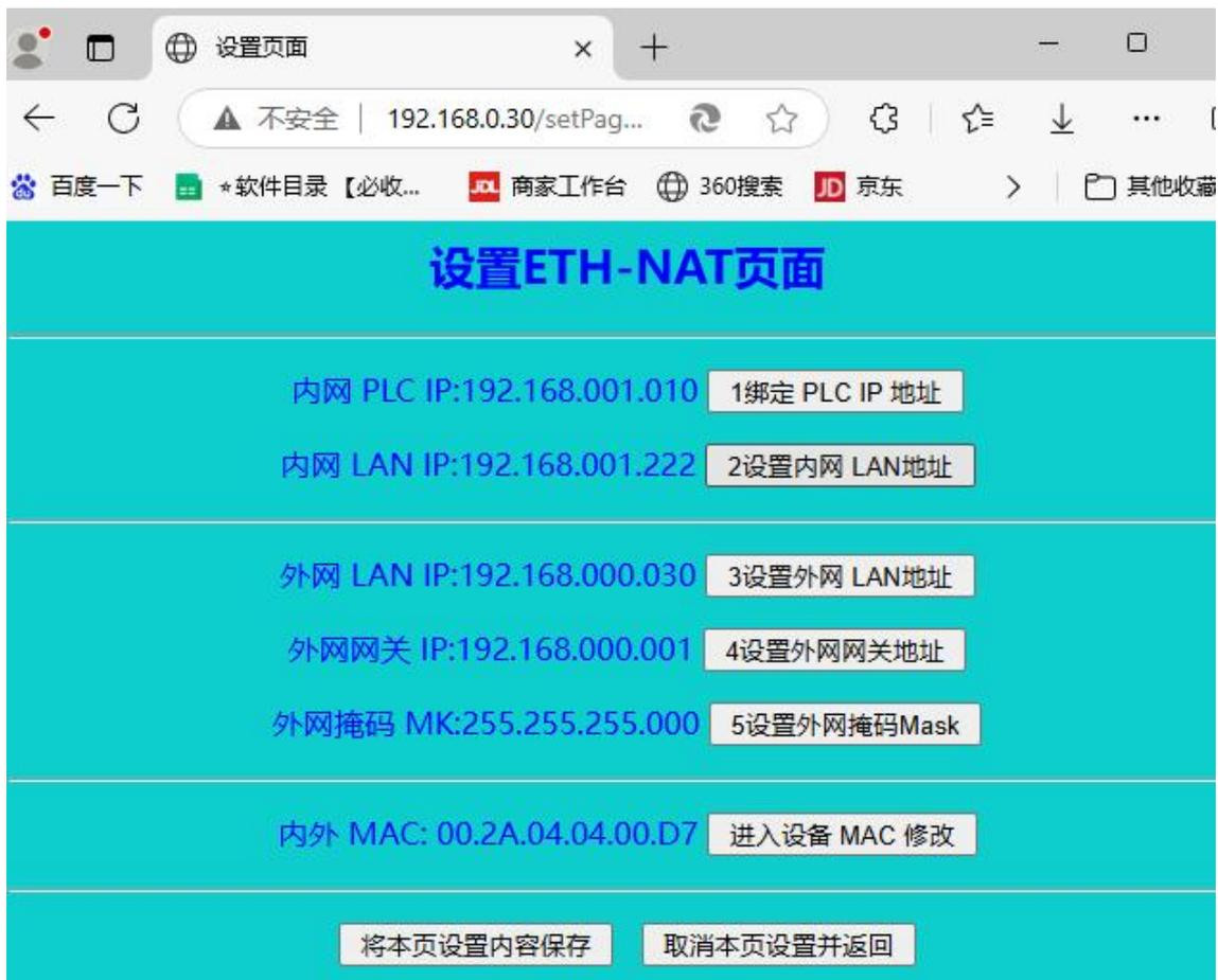
设置 ETH-NAT 内网PLC 的 IP 地址，**必须保证内网LAN的 IP 地址与连接的内网 PLC 的 IP 地址在同一网段**
